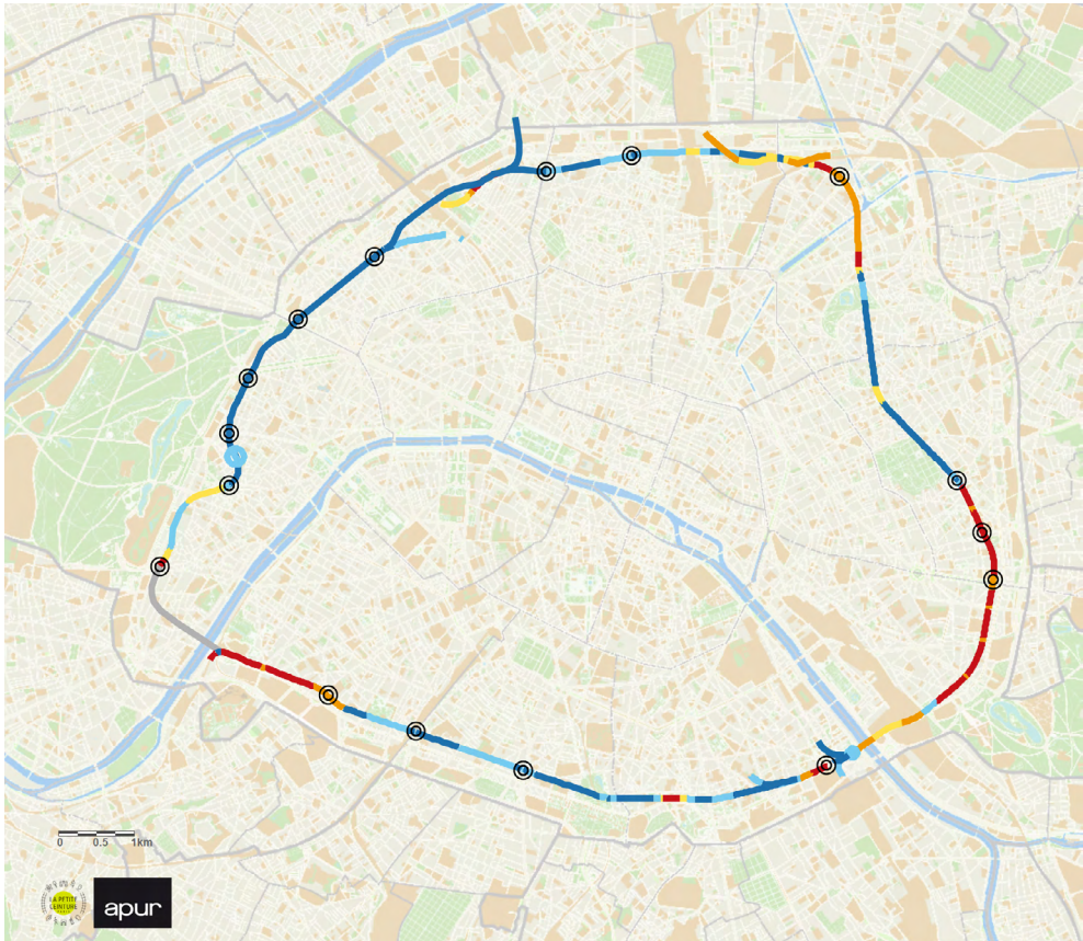
Abb. 2 Die Petite Ceinture im Stadtgefüge von Paris (Quelle: Apur, Ville de Paris 2017; rot: mit Böschungen, orange: Viaduktbauweise, dunkelblau: Tunnel, hellblau: offener Grabenbau, grau: nicht mehr vorhanden, gelb: ebenerdig)
